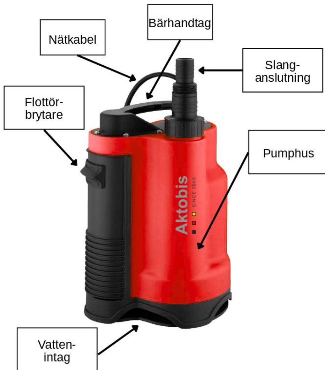
Fig. 1: Smutsvattenpump WDH-SP750 – huvudkomponenter.
